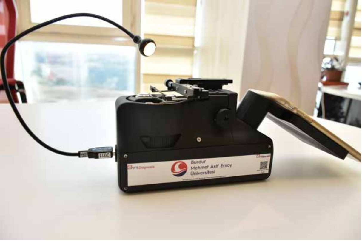
Cep Telefonuna Entegre Mobil Mikroskop ve Tanı Sistemi
