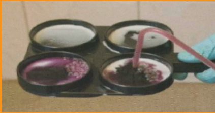
4. Eşit hacimde test sıvısı ekleyin ve içeriğin karışması için bir dakika boyunca çevirin.
