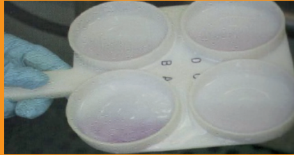
Sonuçları Okuma: Sol alt köşedeki bölmede bulunan sütte yoğunlaşma olduğunu, yani hücre sayısının 500.000 hücre/ml'den fazla olduğunu göstermektedir. Diğer üç bölmedeki sütlerde herhangi bir reaksiyon görülmemektedir.
