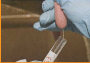
5. Test tüpünün en fazla dörtte üçünü doldurun.
